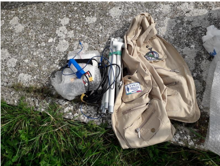
Attrezzatura minimalista per una uscita "quickly ready and go": FT817, batteria LiPO da 1200 mAh , antenna MOXON a filo ripiegabile, cavalletto di supporto
