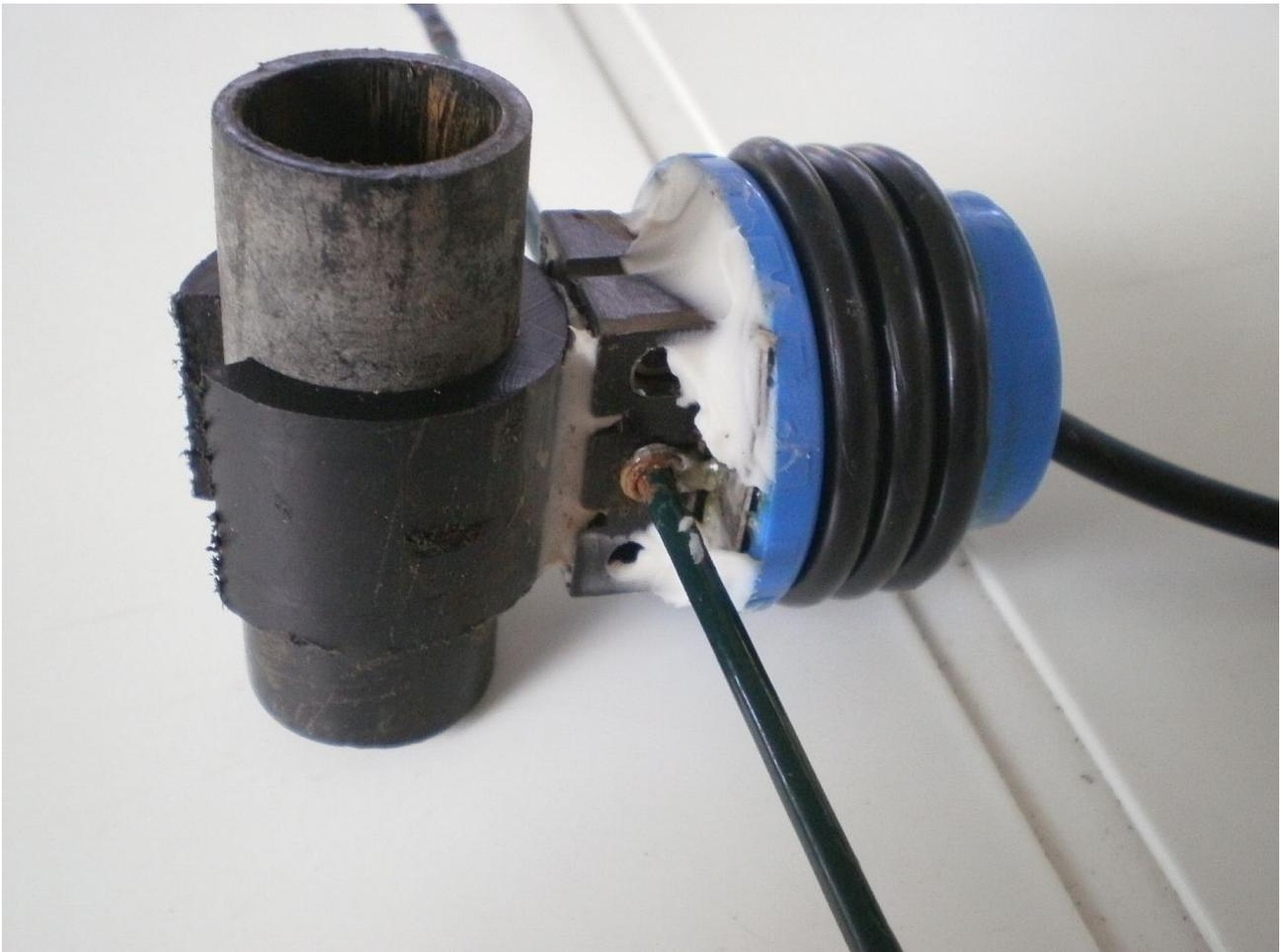
Il grosso tubo di plastica scuro, una volta infilato nel boom, verrà fatto scorrere fino a raggiungere la posizione dovuta.
