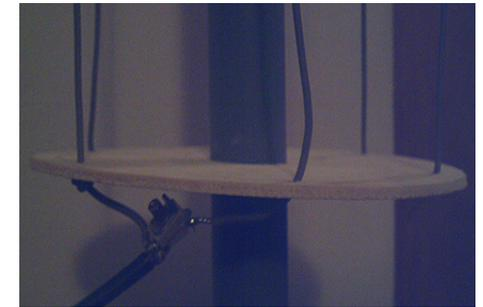
Adattamento impedenza con classico spezzone 75 ohm  $\frac{1}{4}$  onda in RG59.
