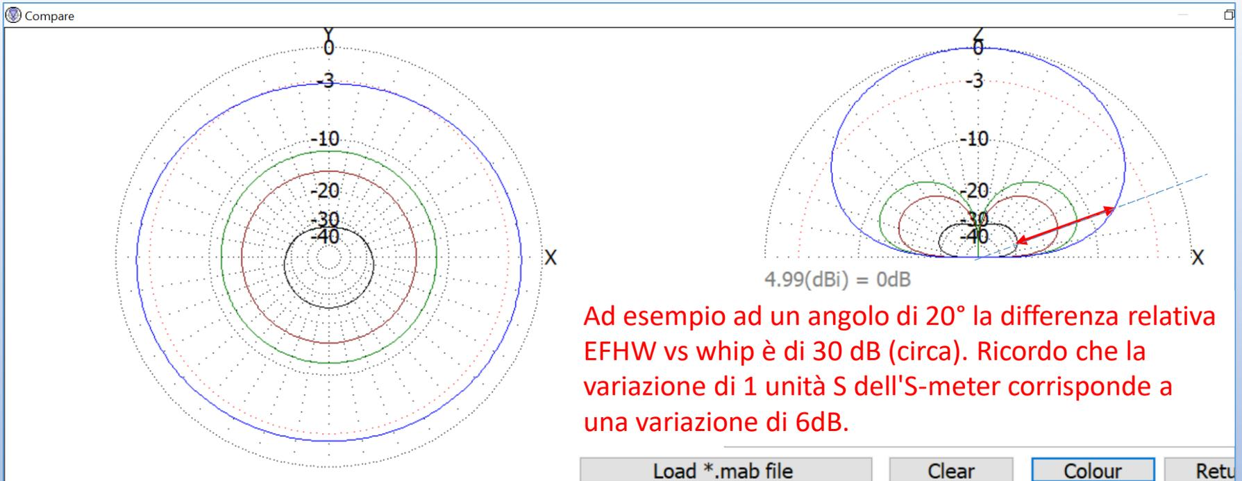
Ad esempio ad un angolo di 20° la differenza relativa EFHW vs whip è di 30 dB (circa). Ricordo che la variazione di 1 unità S dell'S-meter corrisponde a una variazione di 6dB.
