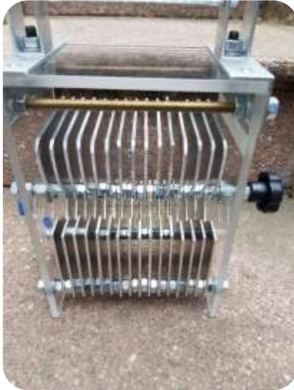
2 rondelle piane con altrettanti dadi autobloccanti affinché si sia creato un certo sforzo durante la rotazione, sufficiente però a mantenere in posizione stabile il pacco di lamelle rotanti.
