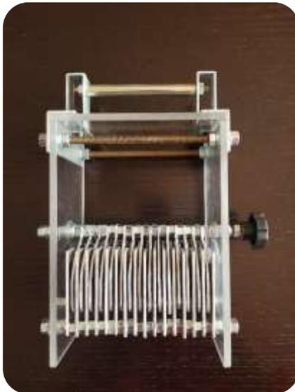
Sempre alla ricerca di qualcosa da fare e sperimentare, nonostante fossi alla prima esperienza, mi è venuta l'idea di auto costruire il seguente condensatore, pur senza imbarcarmi in calcoli ai fini di stabilire l'esatta capacità e relegando quest'ultima quale sorpresa finale.
