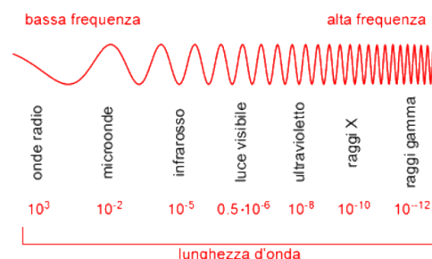
Figura 19 - Una suddivisione dello spettro elettromagnetico
