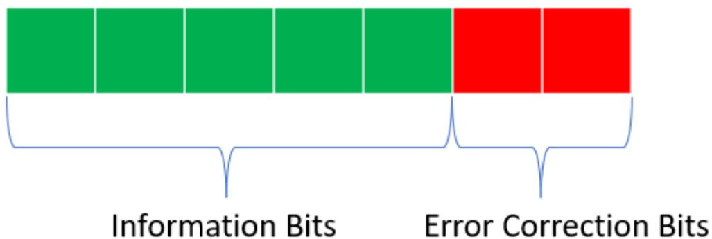
Ovvero 5 bit di informazioni le abbiamo inviate utilizzando in totale 7 bit, due erano per la correzione d'errore.
